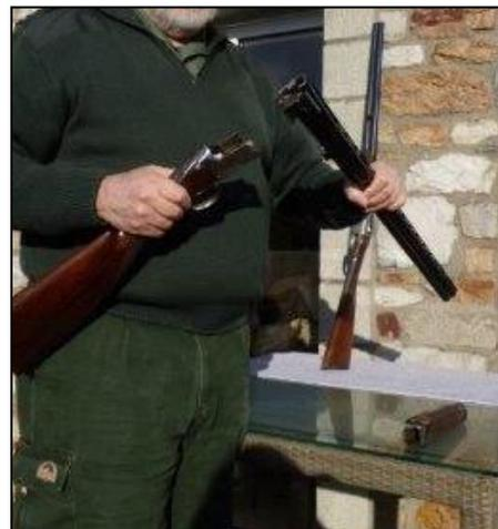
*Rem : le calibre se trouve soit sur le canon, soit sur la bascule.*
